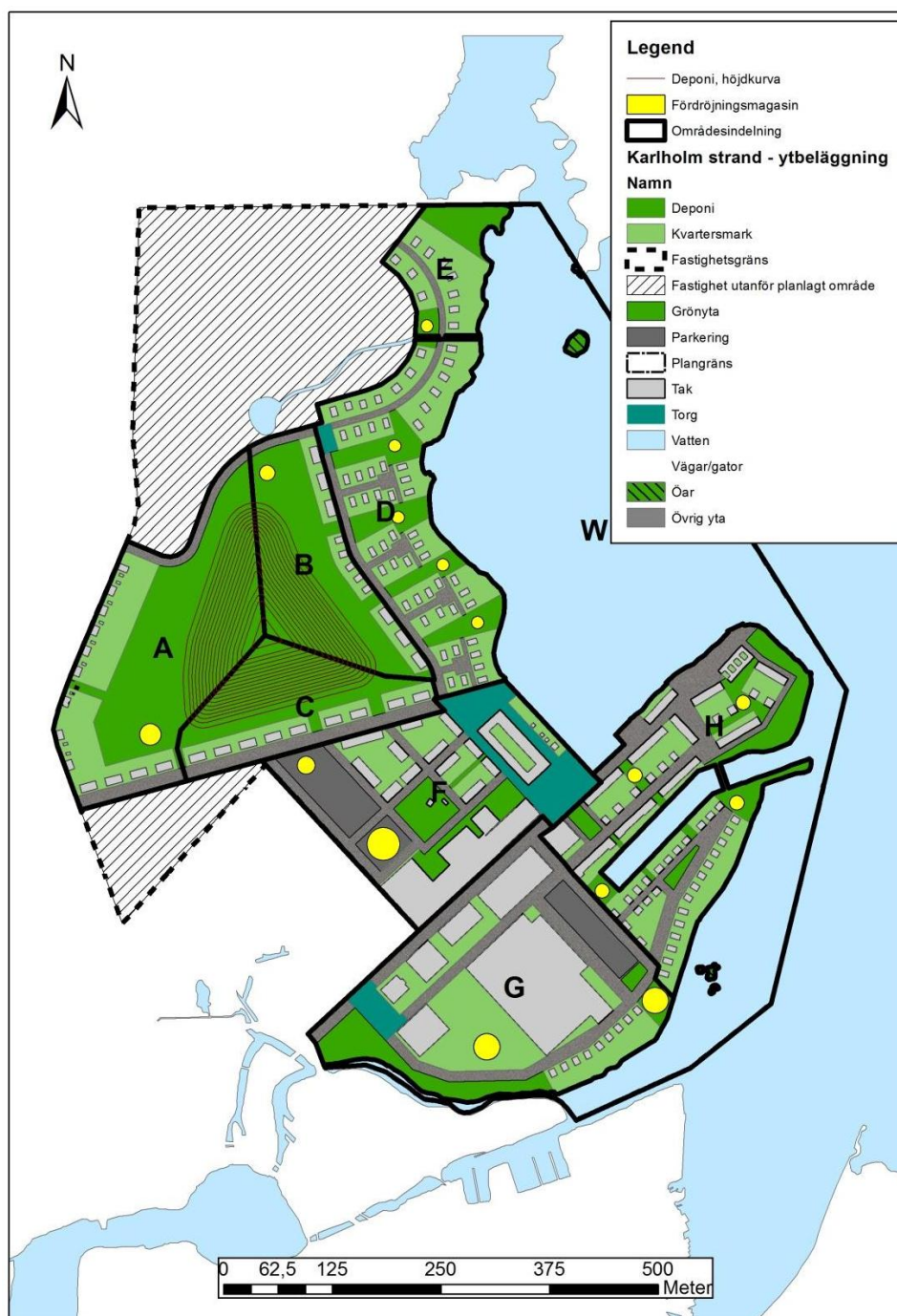
47. Kartbild som visar de olika avrinningsområdena för dagvatten och placering av fördröjningsmagasin, totalt 15 st. (Ramböll 2015-12-29)
