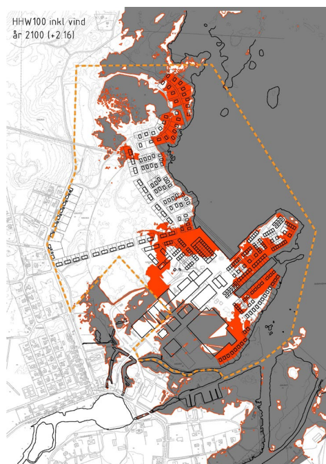
Figur 29: De gråa utgör områden som kan komma att översvämmas år 2100 vid ett 100-årsregn och påverkan från vind. Det röda visar på landområden som kommer att höjas för skydd mot översvämnning enligt planförslaget.
